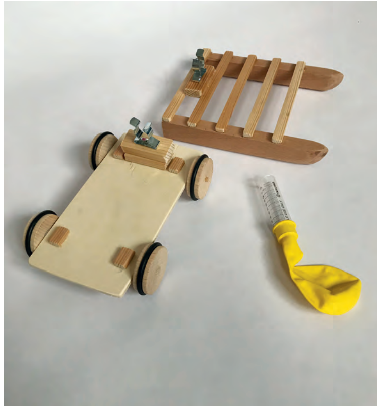
Abb. 1 Der Antrieb kann sowohl auf ein fahrendes als auf ein schwimmendes Fahrzeug aufgesteckt werden
